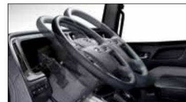
Volante ajustable en altura y profundidad.
